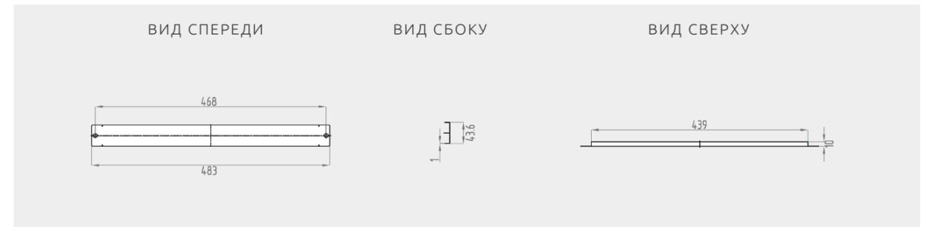
ЧЕРТЕЖ КРЫШКИ С КАБЕЛЬНЫМ ВВОДОМ U CAB COVER 1U
